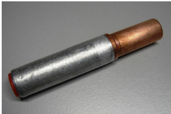
Bimetallische Reduzierverbinder Cu/Al-Verbindung durch Reibschweißverfahren
