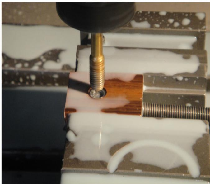
Arbeitsgang: Gewinde (geformt)
