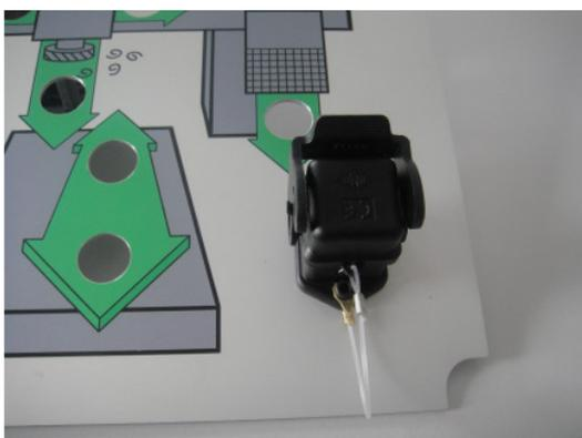
USB-Schnittstelle mit Staubschutzabdeckung verriegelt.
