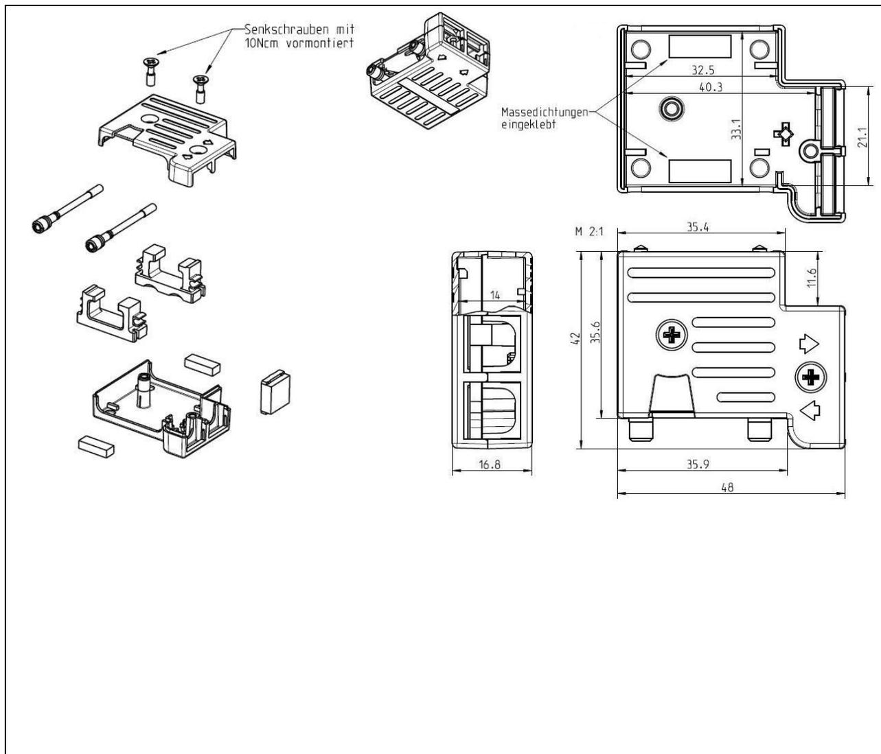
**Bezeichnung** Sub-D Gehäuse, 9-polig, gerade
