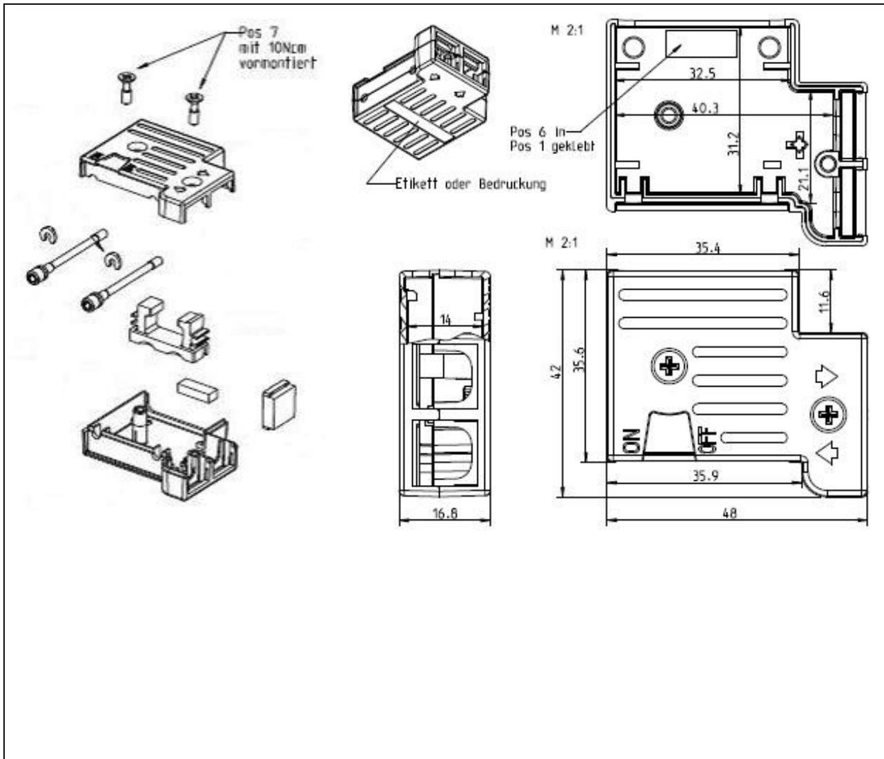
**Bezeichnung** Sub-D Gehäuse, 9-polig, gerade
